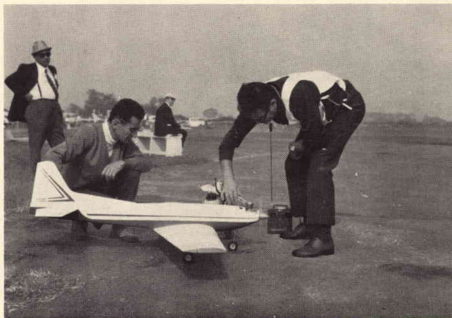
Concorrente in gara si appresta a carburare il motore. Notare l'ala a pianta trapezoidale ed il profilo biconvesso rettangolare.
